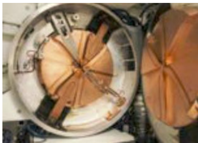
Im Zyklotron MINitrac 700 bringen Magnetfelder Ionen durch wiederholte spiralförmige Bewegungen auf eine sehr große Geschwindigkeit. Das Fluorisotop ^{18}\text{F} entsteht.
